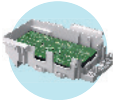
Afgedichte schakelkast & verdikte PCB-coating
